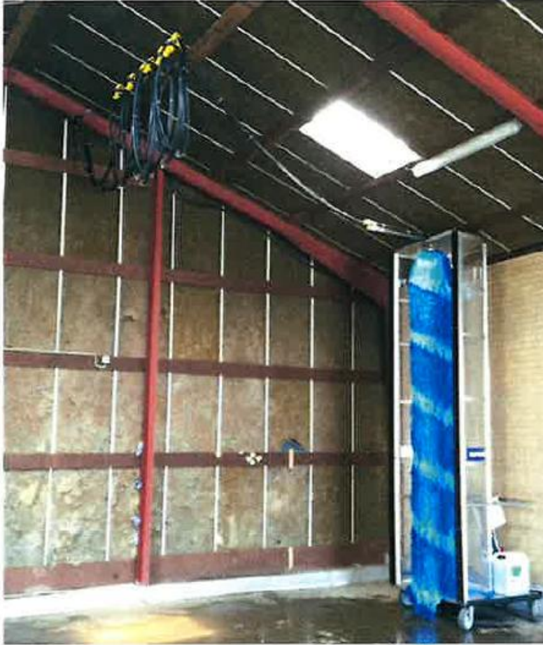
Side Runner er en dansk designet mobil vaskemaskine udført i rustfrit stål.
