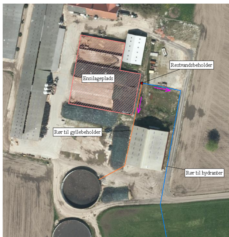
Figur 1: Oversigtskort over restvandsbeholder og rørføring
