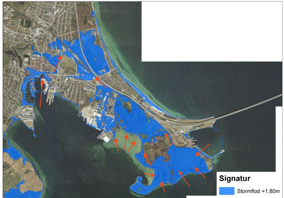
Figur 2-5 Visning af den hydrauliske forbindelse til lavtliggende områder ved stormflod i kote 1,80m.
