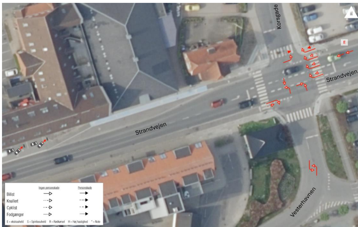
Figur 42 Kollisionsdiagram for trafikulykker i signalkryds mlm. Strandvejen, Korsgade, Vesterhavnen i Nyborg. Der er 12 trafikulykker over 10 årsperiode, hvor 6 er sket siden 2020. Løsningsforslag: Tilbagerykke stopstreger, cykelfelt, før grønt.
