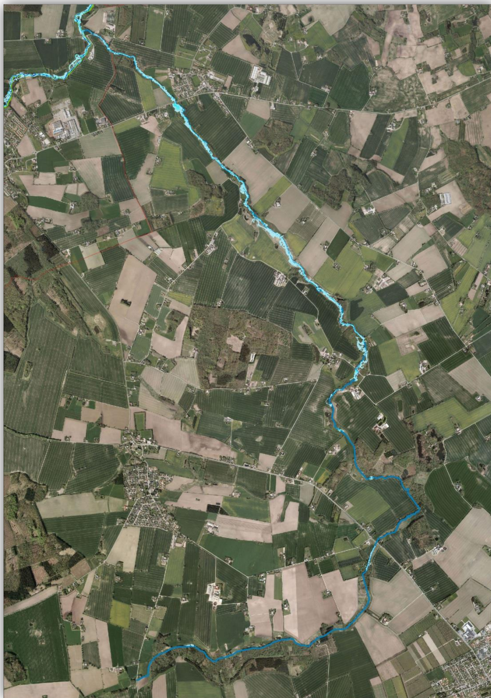
Figur 0-7 Oversvømmelser langs Kastel Å. Langs Kastel Å begrænser oversvømmelserne sig hovedsageligt til de meget vandløbsnære arealer i ådalen, som for store deles vedkommende er udlagt til natur.
